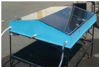
Figure 3 : Distillateur à double pentes (Bou-Ismaïl)
