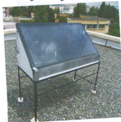
Figure 1 : Distillateur solaire simple pente (khemis miliana)
